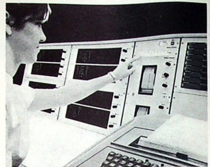
Bild 5. Zentraler Überwachungsplatz mit Rechner-Verarbeitung der Messwerte und alphanumerischer Bildschirmdarstellung für acht Patienten (Westinghouse)
